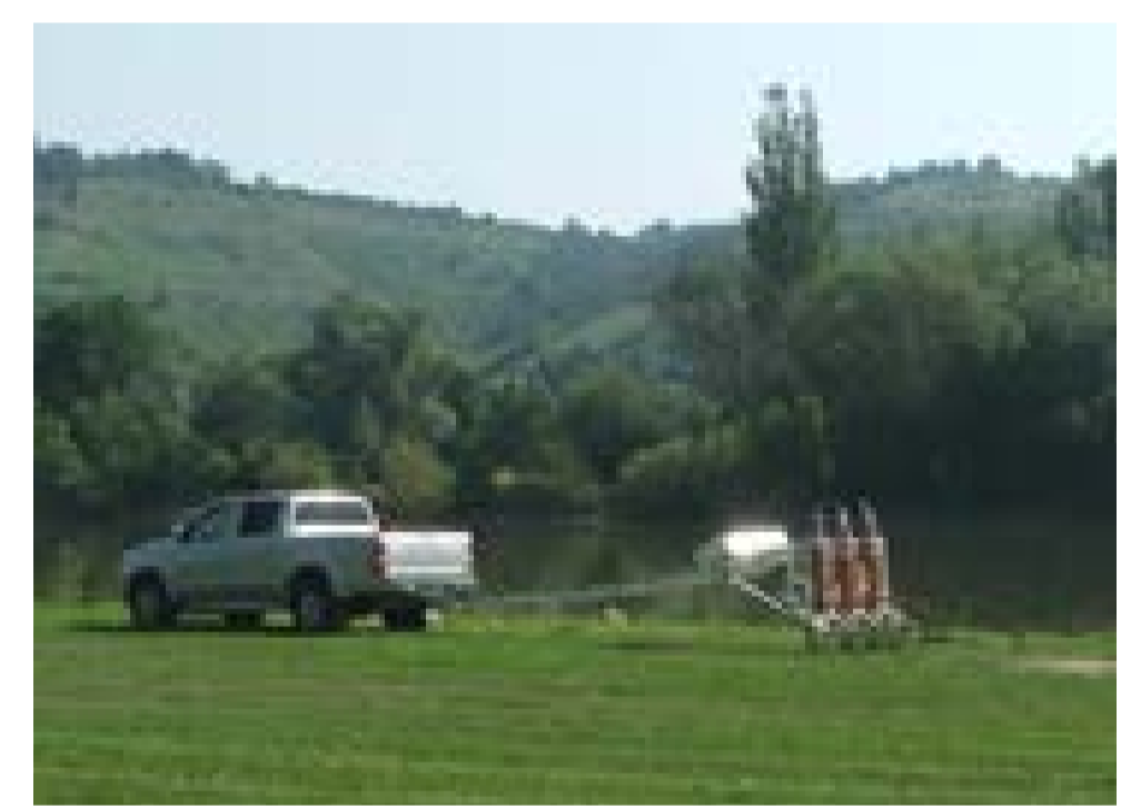
Das SQUID-Meßsystem detektiert magnetische Strukturen im Untergrund am Main bei Karlburg. Dies liefert u.a. Hinweise auf ehemalige Flussverläufe. (Foto: IPHT Jena)
