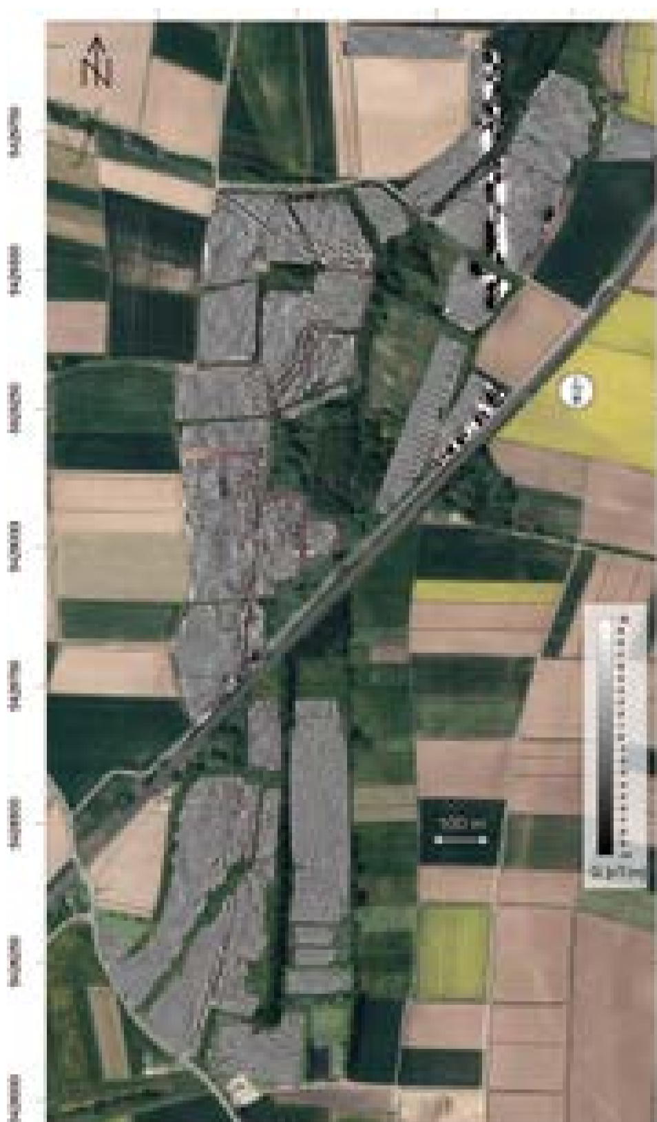
Magnetische Prospektion im Nordabschnitt des Karlsgrabens. SQUID-Gradiometerdaten mit Luftbild. Die Kanaltrasse verläuft in Süd-Nord-Richtung und knickt in der oberen Bildhälfte nach Osten ab. Luftbild: © Landesamt für Vermessung und Geoinformation Bayern 2013 (Grafik: IPHT 2014).
