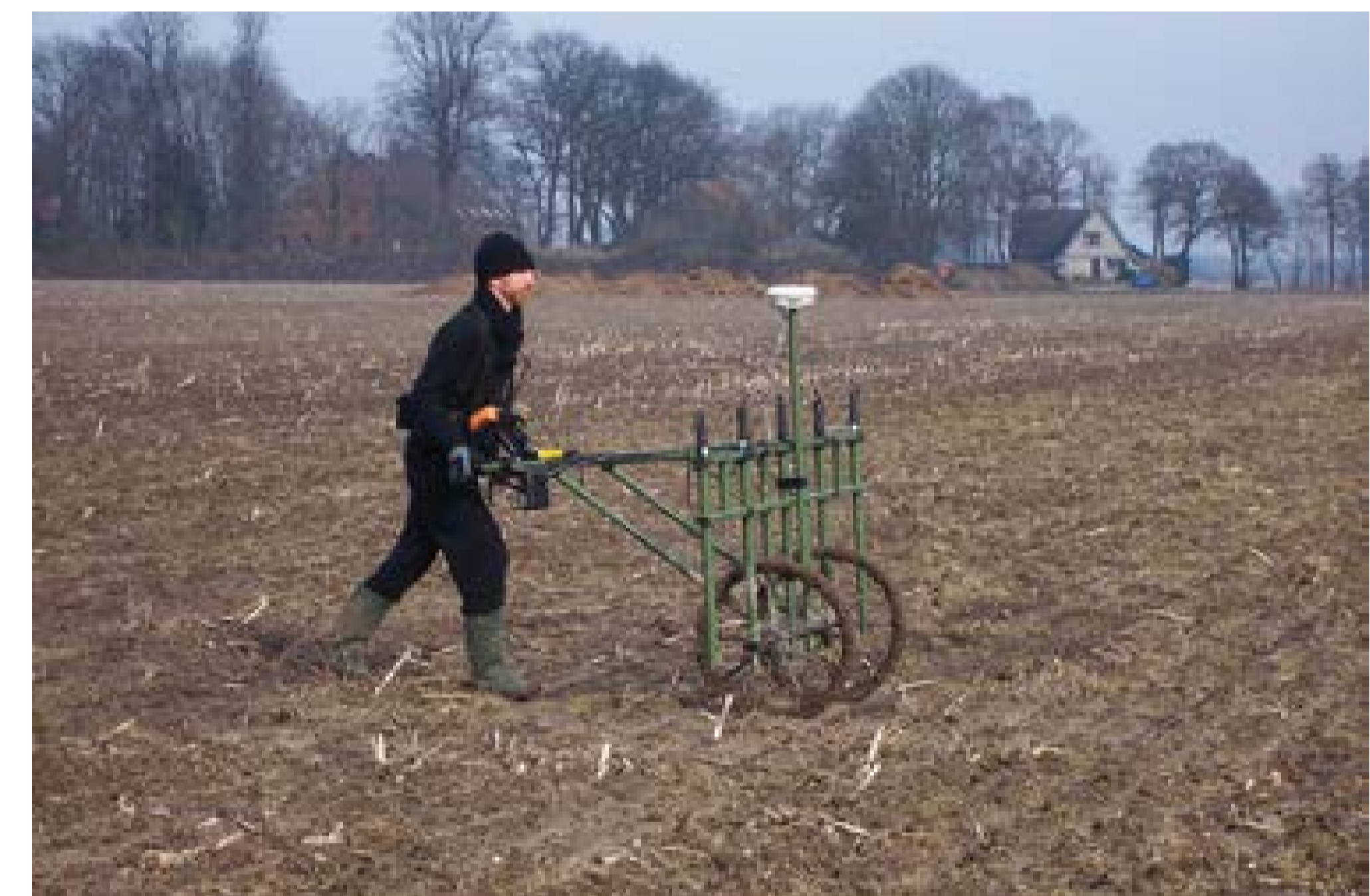
Flächenmessung mit einem Cäsiummagnetometer des NIHK
