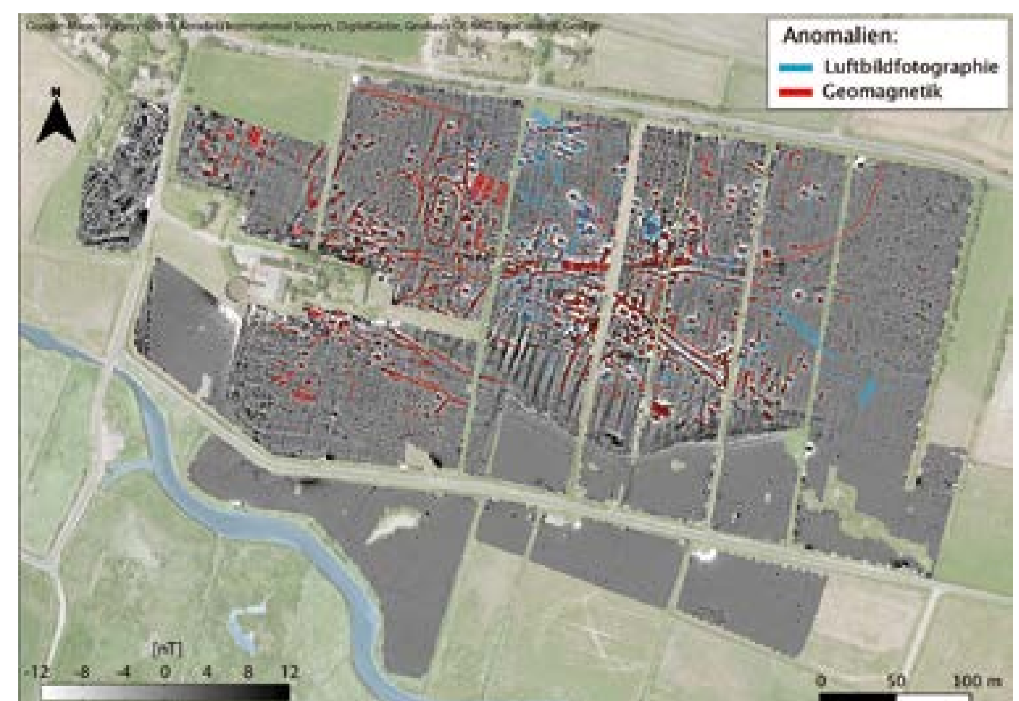
Hochauflösende Karte des Erdmagnetfeldes auf der Insel Föhr. Die Umrisse von Hausresten und Wegen einer Siedlung der Wikingerzeit zeichnen in der Magnetfeldkarte ab (rot umrandete „Anomalien“). Einige dieser Konturen wurden auch in Luftbildern anhand von Bewuchsmerkmalen entdeckt (blau umrandet).
