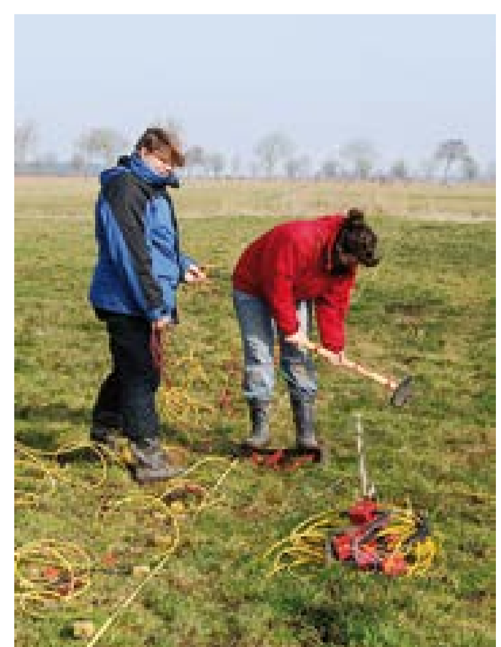
Seismikmessungen zur Untersuchung von verlandeten Prielen in Groothusen
