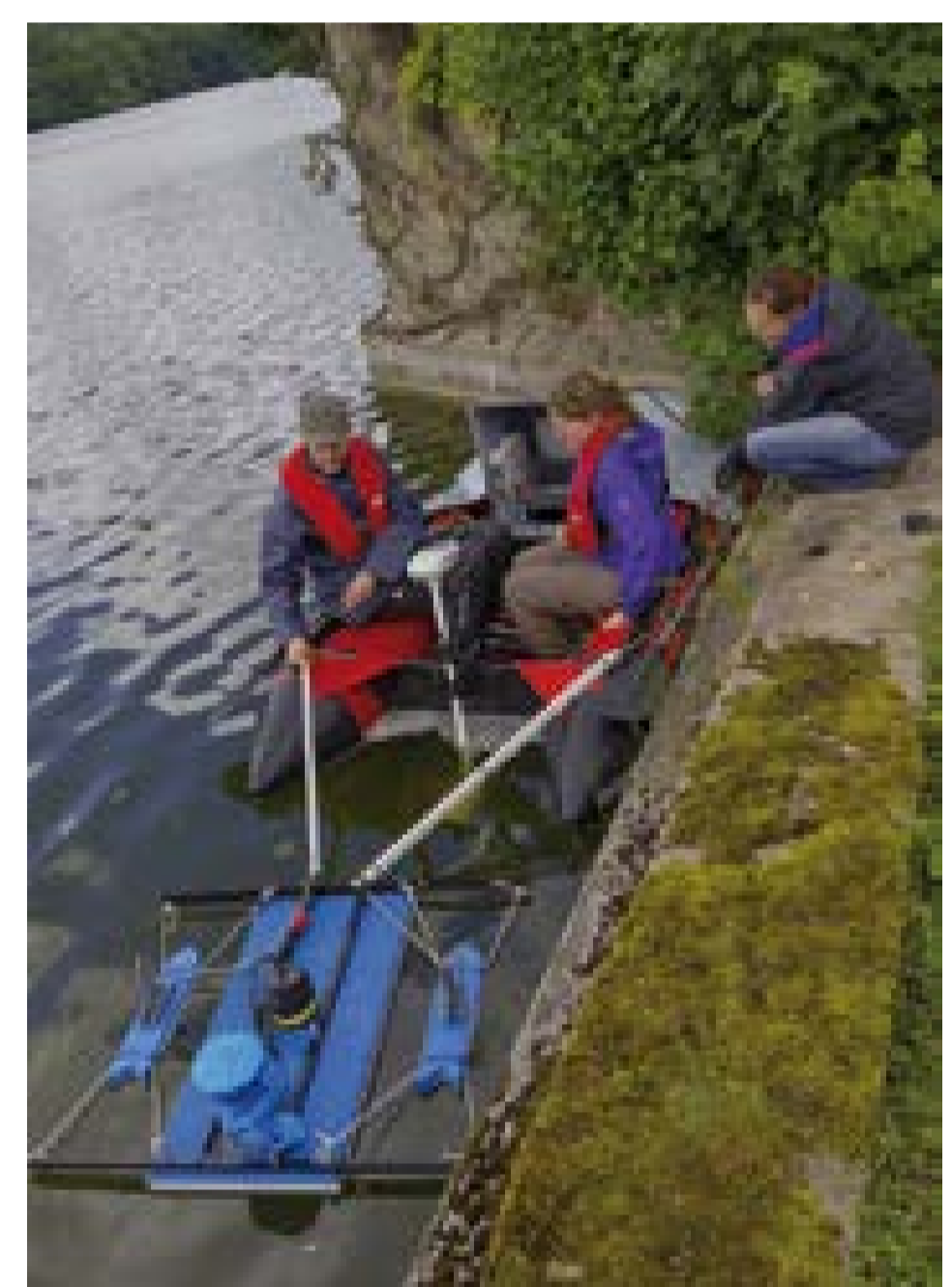
Das neu entwickelte Messsystem zur akustischen Bodendurchschallung bei Messungen im Schlossteich von Glücksburg. Es wird hinter einem Schlauchboot gezogen, das mit einem Elektro-Außenbordmotor angetrieben wird.
