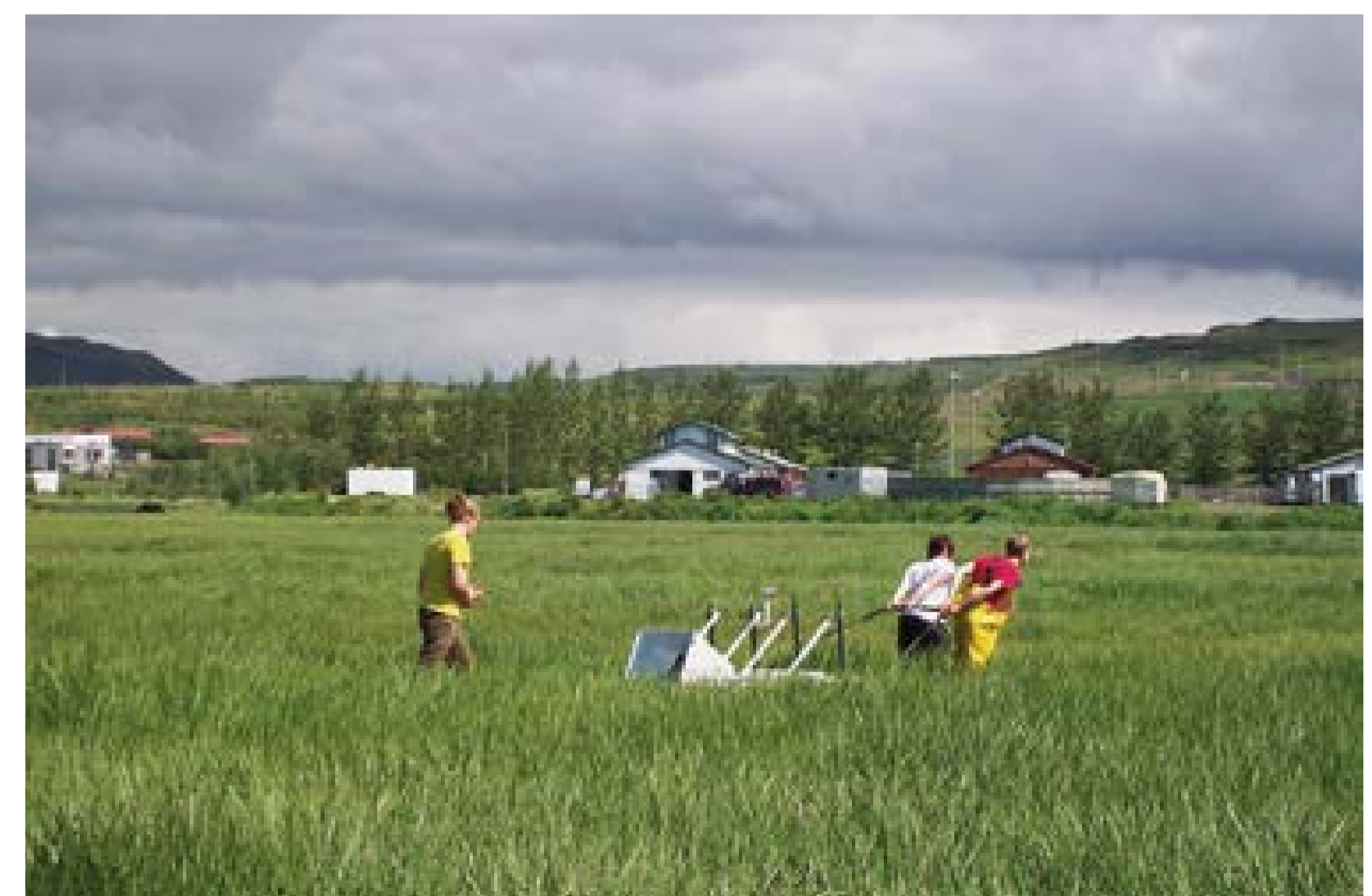
Erdmagnetfeldmessungen in einer verlandeten Bucht auf Island. Wegen des hohen Grases wurde das Messsystem auf einem eigens entwickelten Schlitten montiert.
