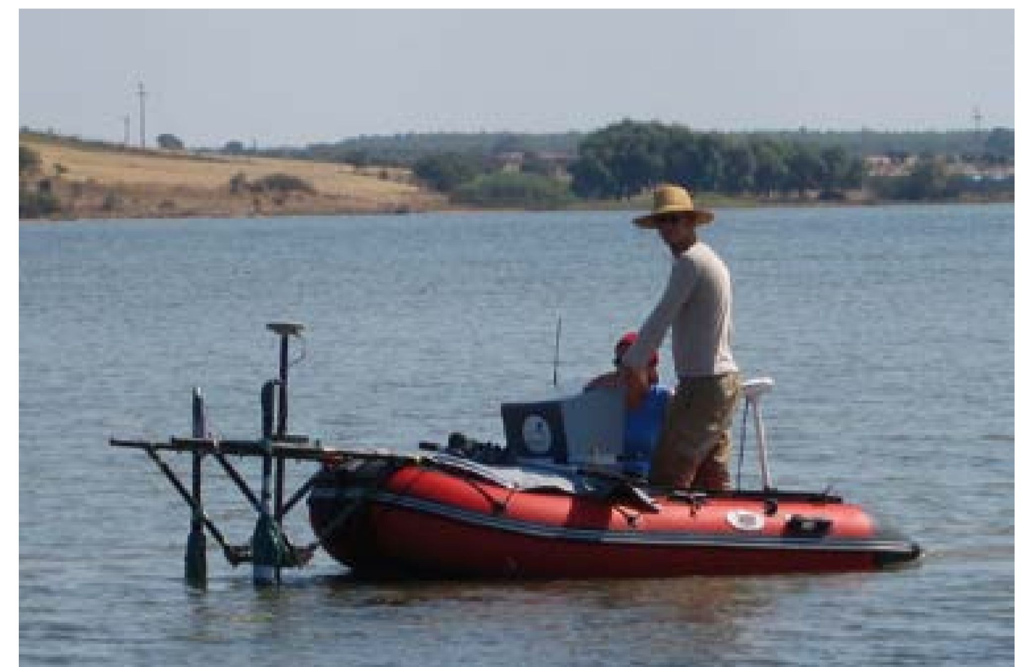
In tieferem Wasser kann das Erdmagnetfeld auch von einem Schlauchboot aus gemessen werden, wie z.B. in möglichen Hafengebiet von Ainos (Türkei).
