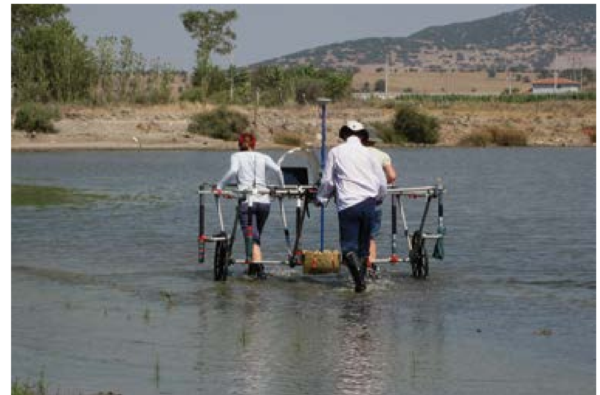
Amphibische Erdmagnetfeldmessungen im möglichen Hafengebiet von Ainos (Türkei) im Flachwasser
