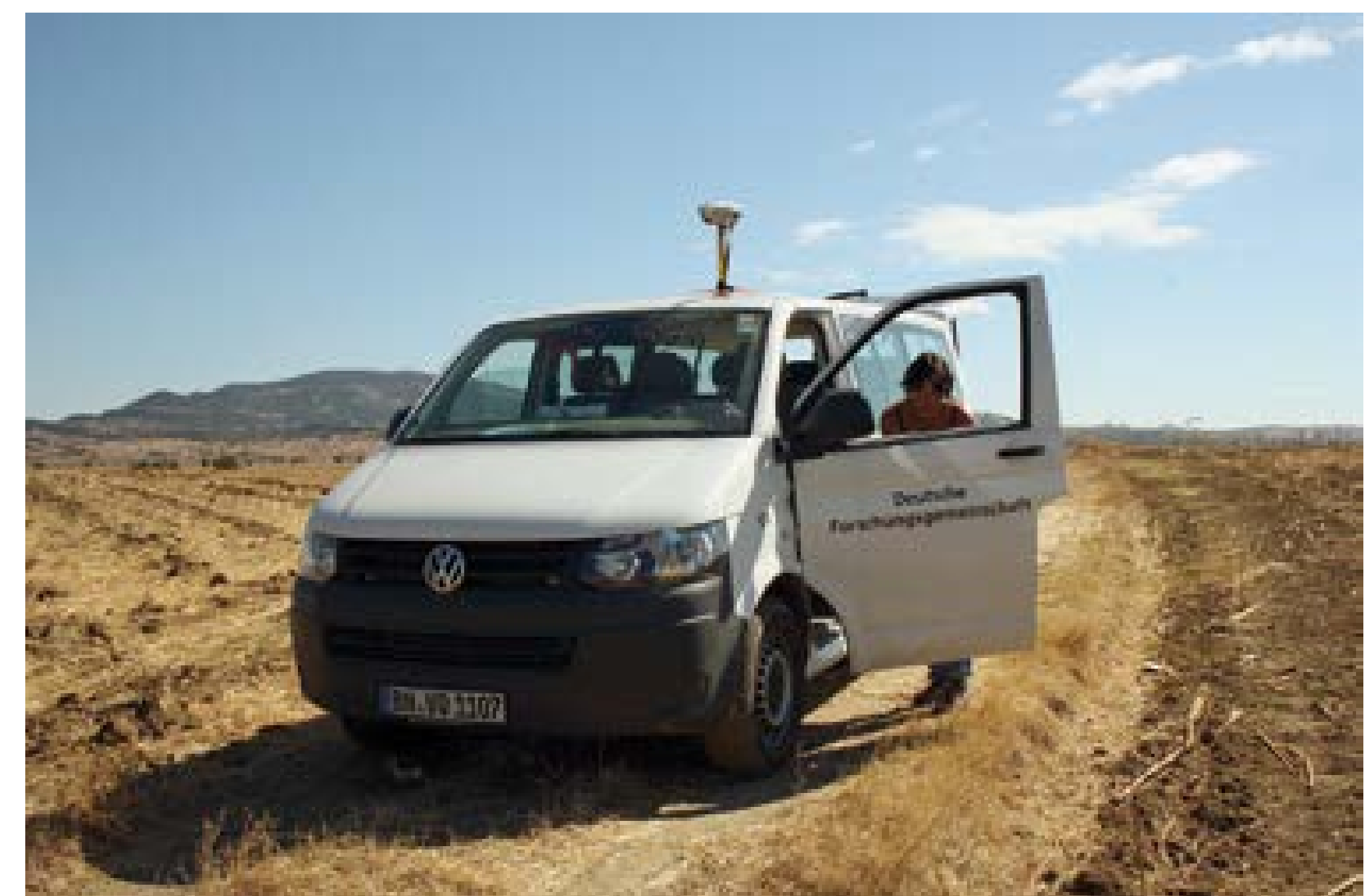
Erfassung der Geländedaten mittels geodätischem GPS auf dem Autodach. Foto: RGZM
